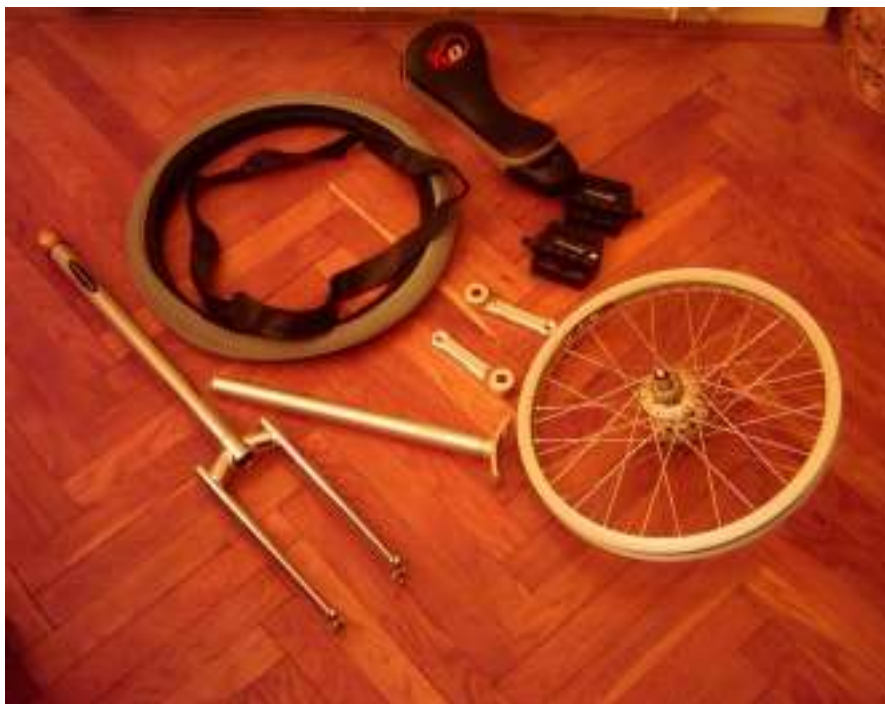
Figure 1: Un monocycle en pièces détachées: roue, pneu et chambre à air, fourche, paire de manivelles, paire de pédales, selle et tube de selle.
