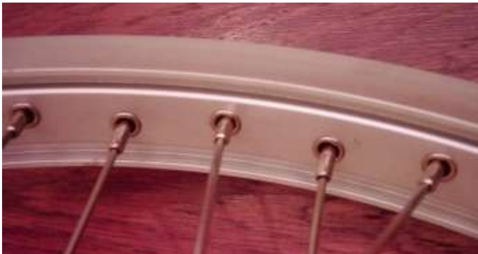
Figure 2: Sur cette jante, les trous de perçage des rayons ont un oeillet.
