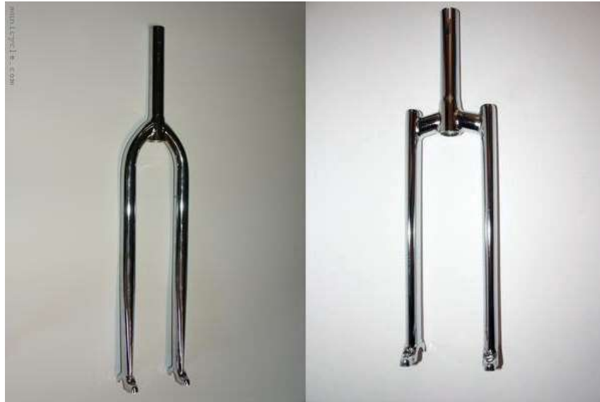
Figure 6: A gauche, une fourche à tête ronde, à droite, une fourche à tête carrée (photo extraite du site municycle.com ).
