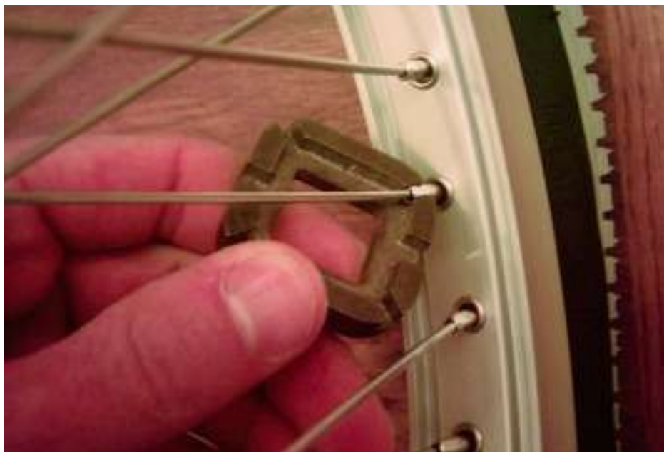
Figure 3: Le serrage des rayons, avec une clef spéciale.
